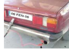
LPG dolumu sırasında topraklama
